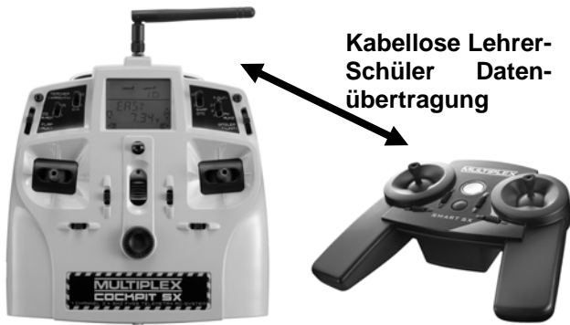
Lehrer-Schüler Betrieb in Verbindung mit einer MULTIPLEX Cockpit SX.
